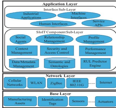
Fig. 1. PdM-SIIoT Architecture
