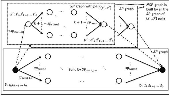
Fig. 4. NSP Graph of  $BCube(n, k)$  when  $sp_{count} < (k + 1)$ .
